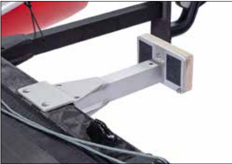
Langschaft-Motor: lange Seite nach oben Long shaft motor: long side up
